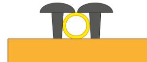
Vorrichtung zum Biegen des Messingröhrchens für das Put-put-Boot. Rohrdurchmesser: 3, 5 – 4 mm
