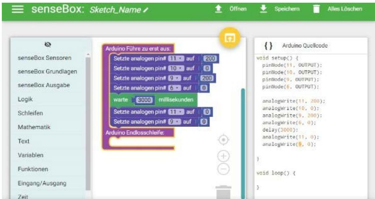
Die in der Abbildung gezeigte Blöcke "Setze analogen pin# .... auf ..." sorgen dafür, dass der jeweils angegebene Pin in Intervallen vom  $\mu$ Controller mit dem Pluspol der Stromquelle in Kontakt gebracht wird. Variiert werden kann das zwischen 0 und 255. Wird so beispielsweise der eine Pol des Motors auf 0, der andere auf 255 gesetzt, dreht der Motor mit voller
