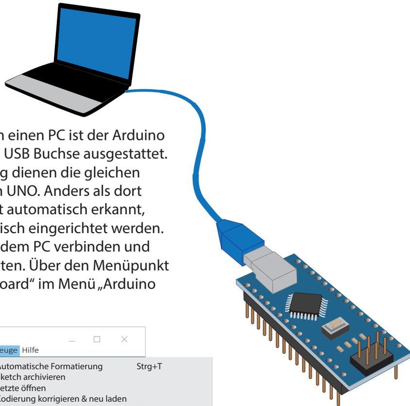
Zum Anschließen an einen PC ist der Arduino Nano mit einer mini USB Buchse ausgestattet. Zur Programmierung dienen die gleichen Editoren wie für den UNO. Anders als dort wird der Nano nicht automatisch erkannt, sondern muss händisch eingerichtet werden. Dazu den Nano mit dem PC verbinden und die Arduino IDE starten. Über den Menüpunkt „Werkzeuge“ und „Board“ im Menü „Arduino Nano“ auswählen.
