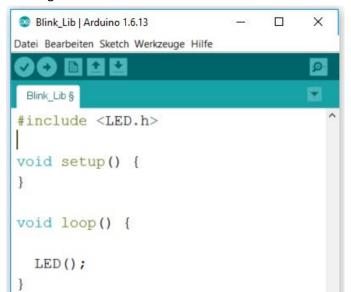
Wird dann der Code auf den Arduino übertragen, fängt die eingebaute LED im Sekundentakt an zu blinken.
