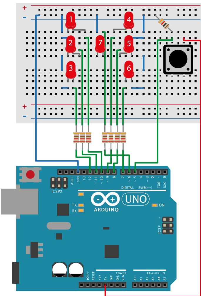
Das Programm wird durch Drücken der Taste auf dem Steckbrett gestartet. Kurz darauf leuchtet eine zufällige Zahl an LEDs auf in der Anordnung wie auf einem Würfel. Wird die Taste erneut kurz gedrückt, verlöschen die LEDs und eine neue Zahl wird generiert. Und so fort.
