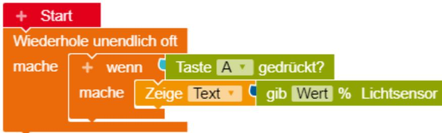
Der Wert des Sensors Umgebungslicht wird in diesem Beispiel dann abgerufen, wenn eine bestimmte Taste (hier A) auf dem Calliope mini gedrückt wird.
