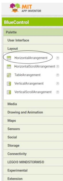
Um die Knöpfe „links“, „rechts“ und „STOPP“ nebeneinanderzulegen, muss in der „Palette“ unter „Layout“ das Feld „Horizontal(Scroll)Arrangement“ auf „Screen1“ platziert werden, in das die „Buttons“ der Reihe nach eingefügt werden. Die „Buttons“ werden über „Properties“ und „Image“ mit passende Grafiken ausgestattet.
